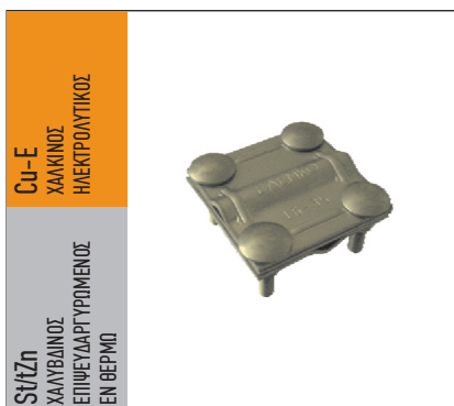
Εικόνα 14: Διμεταλλικός Σύνδεσμος Αγωγών τριών πηκιδίων με ενδιάμεσο ανοξείδωτο πηκιδίο για αποφυγή ηλεκτροχημικής διάβρωσης.
