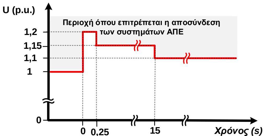
Εικόνα 8: Χαρακτηριστική καμπύλη OVRT
